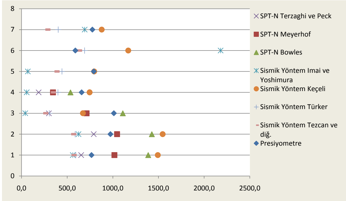
Şekil 4 : Presiyometre, SPT-N ve sismik yöntemlere göre nihai taşıma gücü değerleri.
